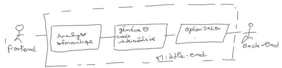
La partie *middle-end* est commune à tous les langages. Elle permet d'effectuer plusieurs transformations successives à partir d'un AST. Sans rentrer dans les détails, on considère que ces transformations successives correspondent respectivement à de l'*analyse sémantique*, à de la *génération de code intermédiaire* et à de l'*optimisation*. A la fin de l'*optimisation*, on obtient une représentation du programme en RTL (*Register Transfer Language*).
