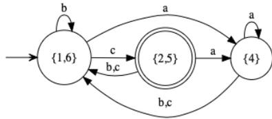
FIGURE 5: Représentation de l'automate minimisé.
