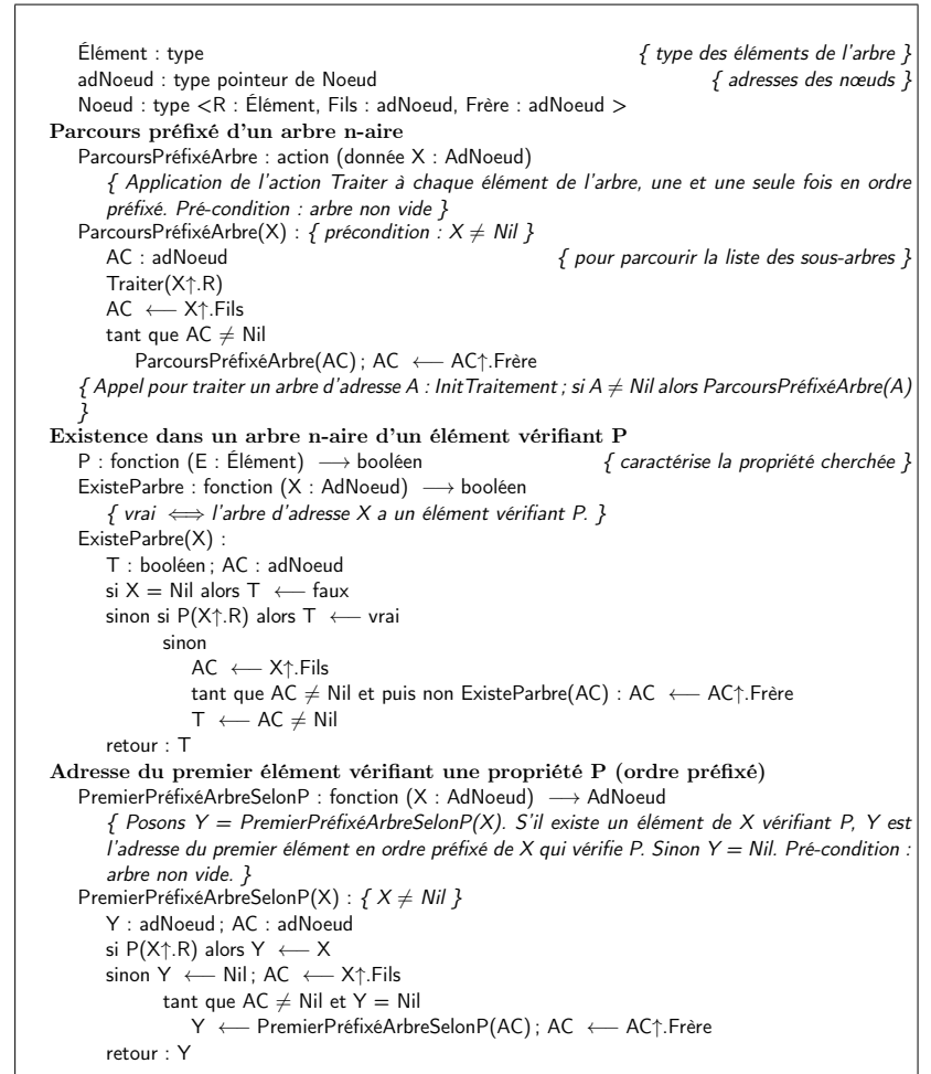
Figure 8.2 – Schémas de traitement séquentiel d'un arbre n-aire
